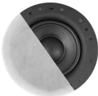
Subwoofer PASSIVO, rotondo, da incasso a controsoffitto, design FRAMELESS. Ideale per sistemi Home Cinema o diffusioni sonore di alta qualità (in abbinamento ai diffusori). Woofer 20 cm a doppia bobina 8Ω. Potenza 250W RMS. Risposta in frequenza 35-200 Hz. Sensibilità 88dB 1W/1mt. Angolo di dispersione 180°. Dimensioni (DxP) 284x104 mm Foro da incasso (D) 258 mm Peso 2 Kg. Colore bianco RAL9016, verniciabile. Cabinet: ABS con griglia di protezione in metallo.
