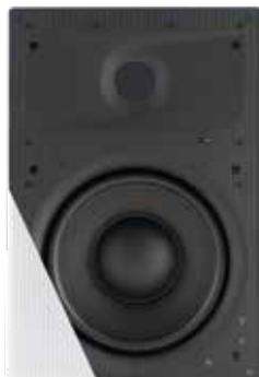
Subwoofer PASSIVO, rettangolare, da incasso a controsoffitto, design FRAMELESS. Ideale per sistemi Home Cinema o diffusioni sonore di alta qualità (in abbinamento ai diffusori). Woofer 20 cm a doppia bobina 8Ω. Potenza 250W RMS. Risposta in frequenza 35-200 Hz. Sensibilità 88dB 1W/1mt. Angolo di dispersione 180°. Dimensioni (LxHxP) 242x362x135 mm. Foro da incasso (LxH) 220x340 mm. Peso 2,1 Kg. Colore bianco RAL9016. Cabinet: ABS con griglia di protezione in metallo.
