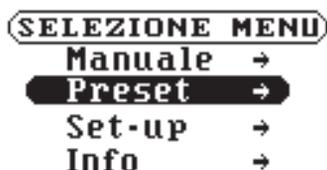
Dal menu' iniziale, ruotando la manopola, sulla voce Preset e selezionandola è possibile scegliere una delle configurazioni memorizzate in precedenza.
