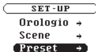
Selezionando Preset dal menu' Set-Up è possibile creare delle configurazioni di ingresso e uscita, memorizzandole per un successivo richiamo. I Preset, a differenza delle Scene viste in precedenza, possono essere richiamati solo manualmente e non hanno la funzione Timer.
