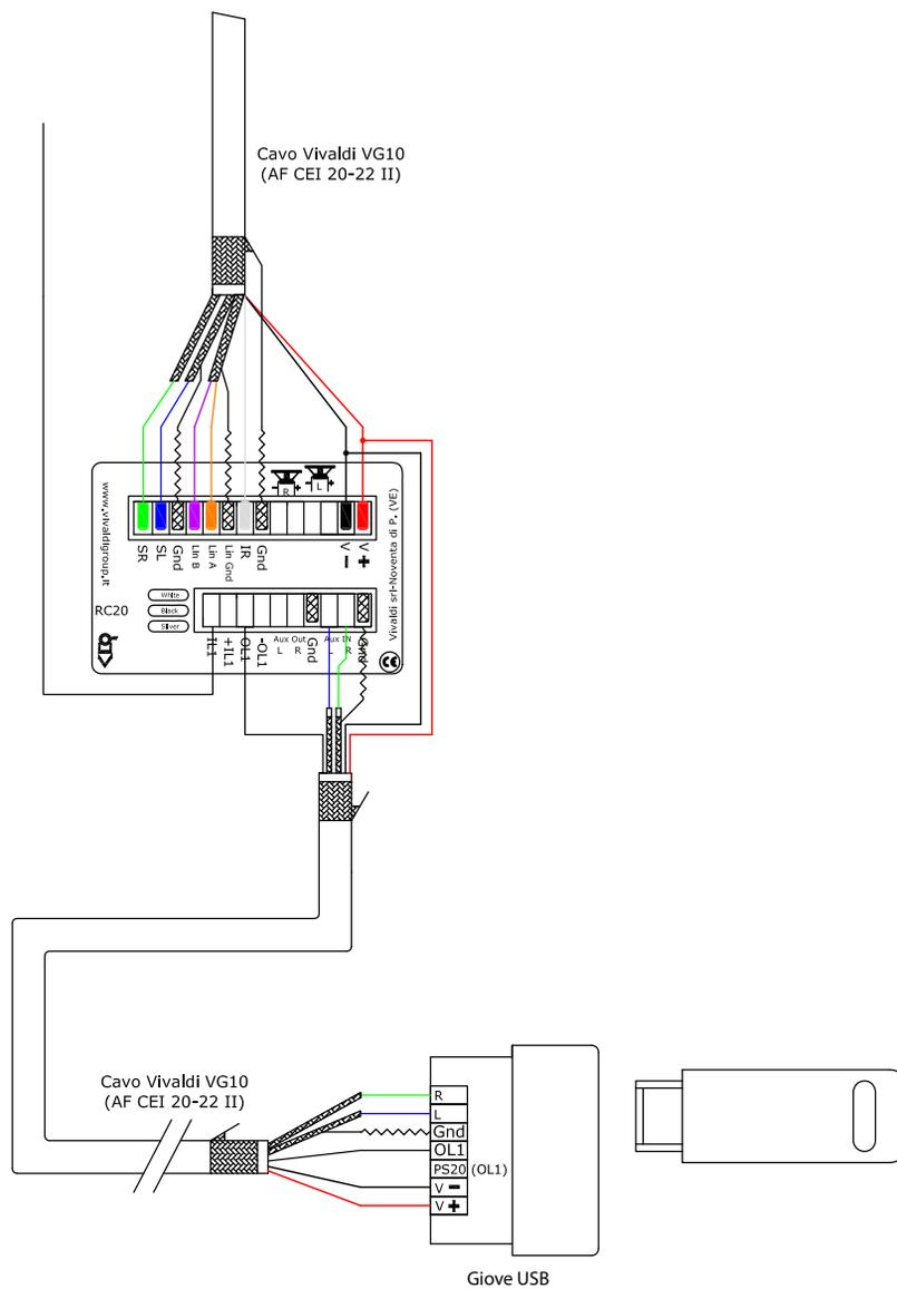
\_\_Per il collegamento di Giove USB seguire lo schema sopra, utilizzando il cavo VG10. \_\_Per ascoltare il lettore MP3 Giove USB, selezionare sul comando RC20, la sorgente ingresso AUX IN
