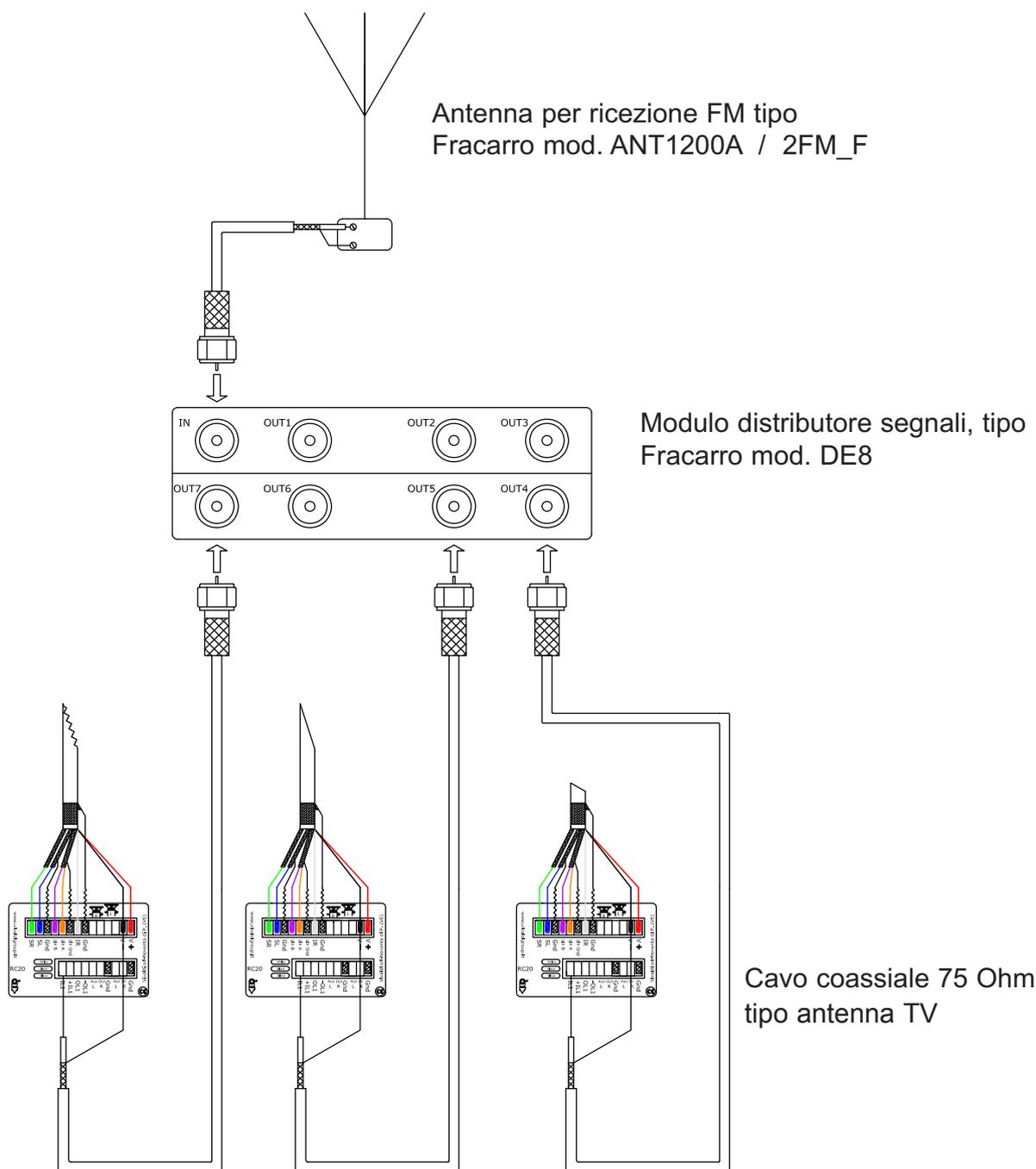
Per ottimizzare la ricezione del sintonizzatore interno al comando RC20, si consiglia di collegare sempre un filo con una lunghezza di 80 cm circa, al morsetto "IL". Se possibile disporlo verso l'alto, all'interno della tubazione elettrica in modo da migliorare ulteriormente la ricezione.
