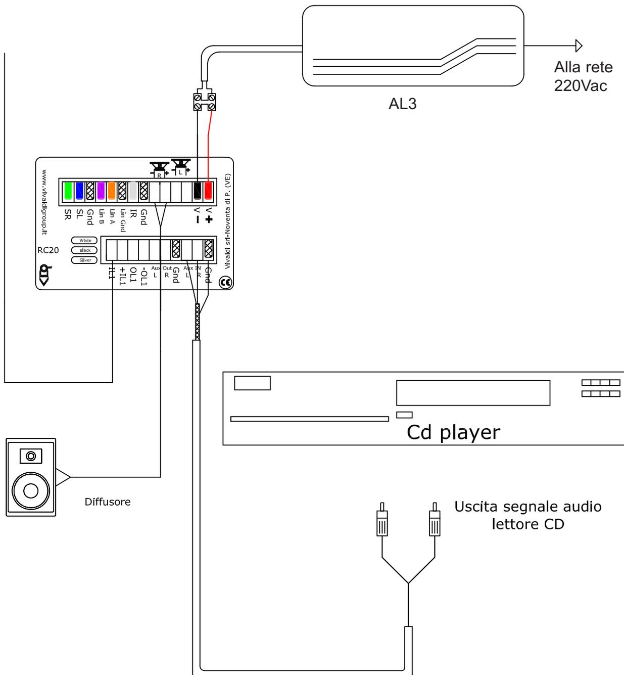
Schema di collegamento di un comando RC20 con alimentatore AL3.
