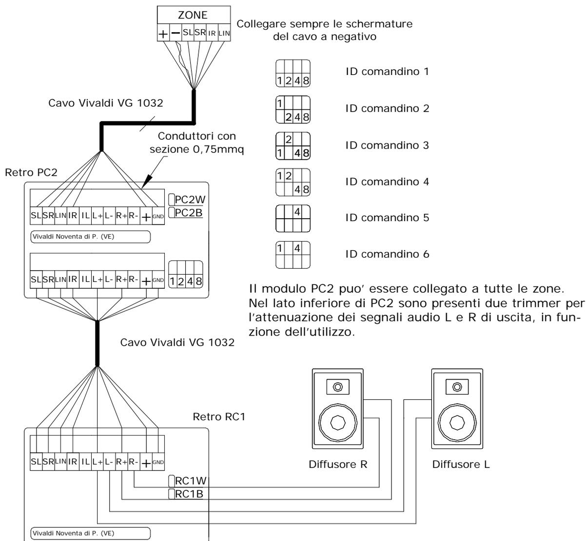
Il modulo attivo PC2, dispone di un ingresso audio per il collegamento di una sorgente locale (ad esempio un lettore CD, o un TV). L'ingresso locale viene abilitato dal comando RC1 della stessa zona, selezionando l'ingresso (ch) numero 7. Il dip-switch deve essere indirizzato con il numero di indirizzo del comando -1, seguendo gli esempi di numerazione binaria riportati.
