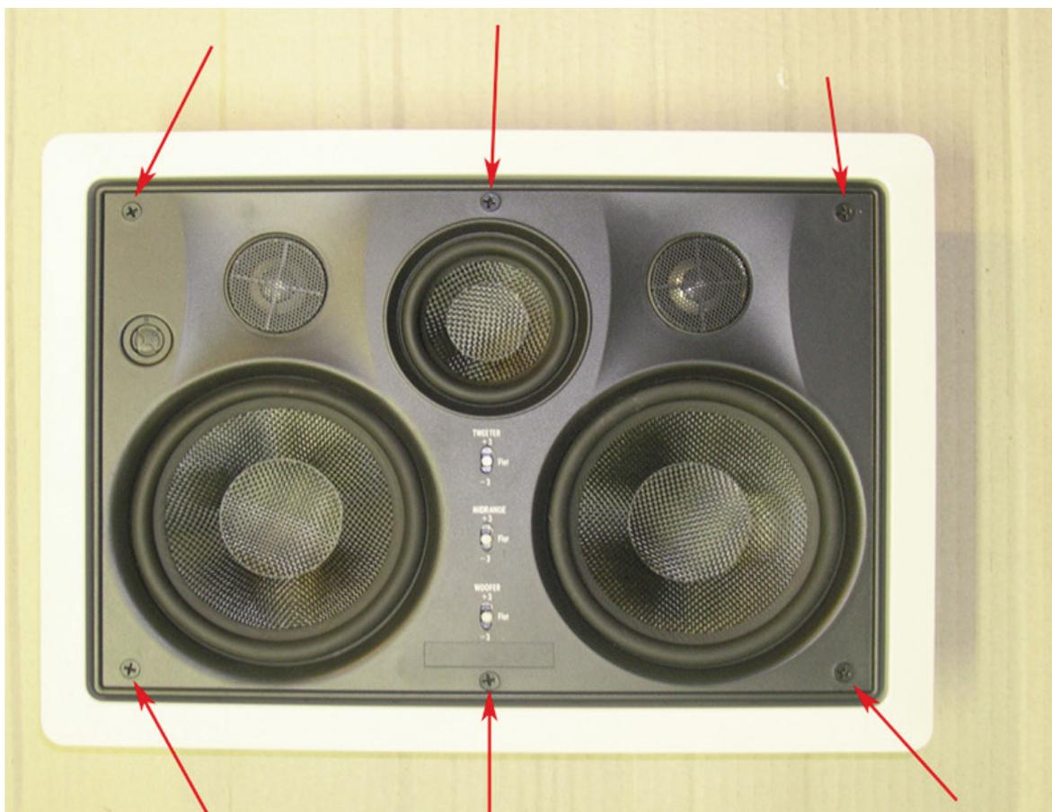
2 – Sulla superficie di gesso rivestito della parete interessata tracciare il perimetro del foro da praticare utilizzando come dima il telaio di materiale plastico bianco appena tolto (perimetro esterno). Assicurarsi con una livella a bolla d'acqua che la tracciatura sia perfettamente a livello: nelle successive fasi di lavorazione non saranno possibili altre regolazioni!
