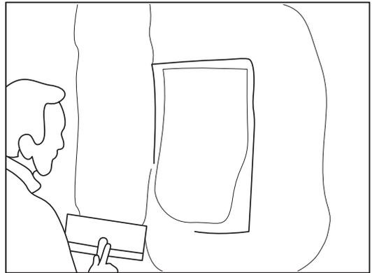
15. Stendere il composto per minimizzare i segni lasciati dagli strumenti. Costruire più coperture secondo il necessario per ottenere una superficie perfetta.
