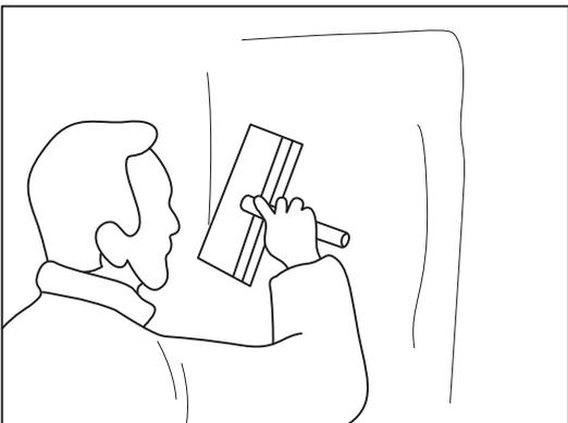
16. Dopo che la copertura finale si è asciugata utilizzare una levigatrice manuale sull'intera superficie del muro. La superficie del muro non dovrebbe mostrare segni del diffusore.
