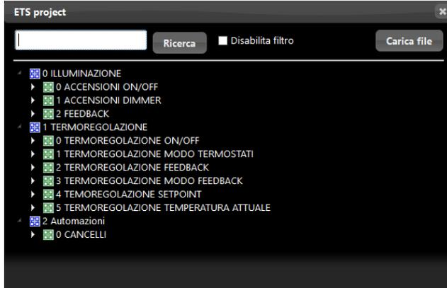
Esempio di importazione automatica del database di un progetto KNX e dell'autocomposizione Vivaldi
