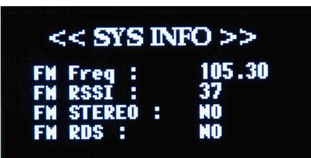
Schermata SYS INFO numero 4. Viene riportata la frequenza corrente della radio FM, il valore RSSI di intensità del segnale radio di quella frequenza, il tipo di segnale, se stereo oppure no e la presenza o meno dell'RDS sempre relativi alla frequenza in ascolto. Se sul dispositivo FREEMK2 e FREENETMK2 è selezionata la sorgente RADIO FM e si va a visualizzare questa schermata, tramite il telecomando ad infrarosso TCIR5 in
