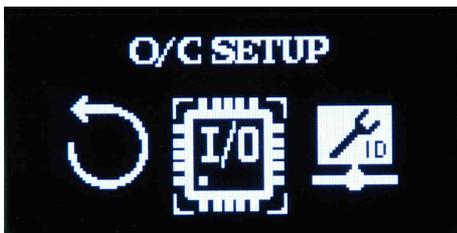
Schermata del menù ADV SETUP che identifica la pagina O/C SETUP. FREEMK2 e FREE∅ETMK2 dispongono di tre pin a morsetto definiti OC1, OC2 e IL (OC3) che sono degli open collector bidirezionali che permettono alcune funzioni tra i vari dispositivi collegati e il controllo degli accessori VIVALDI. Premere il tasto ENTER per accedere alla schermata di modifica degli OC.
