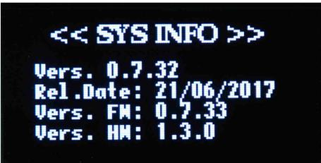
Schermata SYS INFO numero 2. Viene riportata la versione del firmware installato sul dispositivo, la data di rilascio del firmware e la versione dell'hardware del dispositivo. Premere i tasti << e >> oppure i tasti + e - per visualizzare la schermata successiva.
