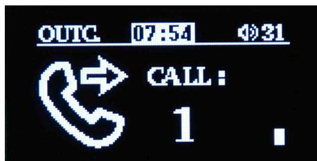
Con i tasti + e – si sceglie verso quale altro ID del bus RS485 (FREEEmk2 collegato al sistema) aprire la comunicazione microfonica. Una volta selezionato l'ID desiderato o una volta selezionato ALL per chiamare tutti i dispositivi del sistema, premere il tasto ENTER per eseguire la chiamata.
