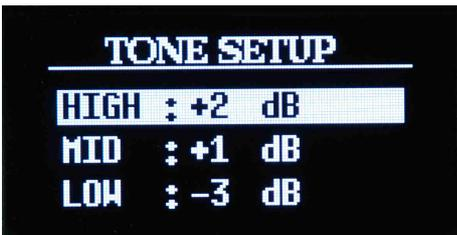
Schermata di modifica TONE SETUP. In questa schermata si trovano le tre bande di frequenza da modificare, HIGH, MID, LOW. E' possibile modificare le tre bande di frequenza da un valore minimo di - 10 dB ad un valore massimo di + 10 dB. Utilizzare i tasti << e >> per spostarsi da una banda all'altra. Utilizzare i tasti + e - per modificare il valore della banda selezionata. Una volta eseguite le modifiche confermare
