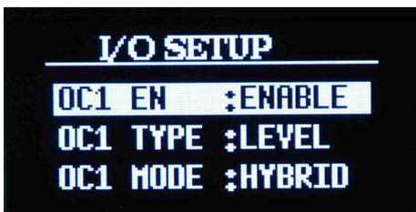
Schermata di modifica I/O SETUP. Il pin OC1, collegato in parallelo tra più FREEMK2 e FREE∅ETMK2 permette di usufruire della chiamata microfonica, univoca e selettiva, tra i vari dispositivi. Utilizzare i tasti << e >> per spostarsi da un parametro all'altro. Utilizzare i tasti + e - per modificare il parametro selezionato.
