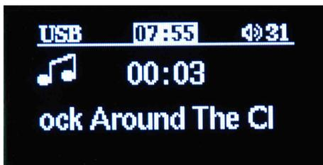
Schermata sorgente USB. Si possono connettere alla porta USB solamente memorie di archiviazione di massa come pendrive USB con file system FAT16 o FAT32. La capacità massima accettata della pendrive USB è di 8 GB. La lettura e riproduzione dei file avviene partendo dal primo brano in radice della memoria e passando poi al primo brano della prima cartella (se presente, massimo 65534 cartelle) e così via.
