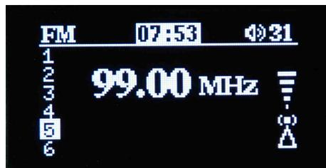
Schermata sorgente RADIO FM. Frequenze ricevibili da 87,5 MHz a 108,0 MHz. Distinzione tra frequenze mono e stereo (comparsa della sigla ST in alto, a destra dell'ora). Visualizzazione delle informazioni RDS, quando disponibile, al centro, sotto il valore della frequenza in ascolto. I numeri in colonna a sinistra indicano le 6 memorie FM del dispositivo e, se evidenziate, significa che la frequenza in ascolto è
