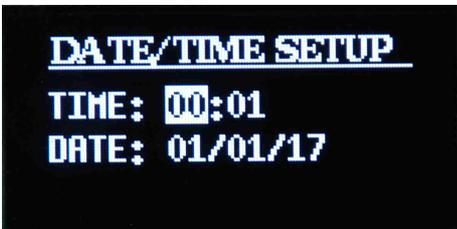
Schermata di modifica DATE/TIME SETUP. In questa schermata è possibile modificare manualmente data e ora del dispositivo. Utilizzare i tasti << e >> per spostarsi tra ore, minuti, giorno, mese e anno. Utilizzare i tasti + e - per modificare il parametro selezionato. Una volta eseguite le modifiche confermare premendo il tasto ENTER.
