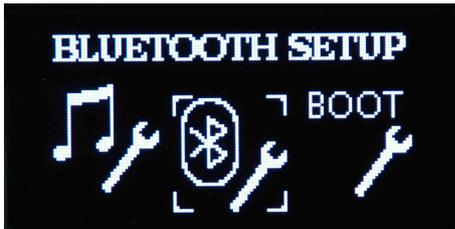
Schermata del menù ADV SETUP che identifica la pagina del BLUETOOTH SETUP. Da questa pagina è possibile configurare alcuni parametri di FREEMK2 e FREENETMK2 riguardanti il dispositivo Bluetooth integrato. Premere il tasto ENTER per accedere alla schermata di modifica.
