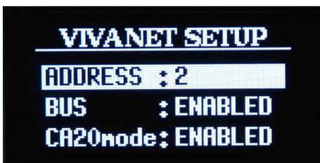
Schermata di modifica VIVANET SETUP. E' possibile da questa pagina modificare l'indirizzo del dispositivo FREE∅ETMK2 sul bus RS485, attivare o disattivare il bus RS485 e attivare o disattivare il CA20MODE. Utilizzare i tasti << e >> per spostarsi da un parametro all'altro. Utilizzare i tasti + e - per modificare il parametro selezionato. Una volta eseguite le modifiche confermare premendo il tasto ENTER.
