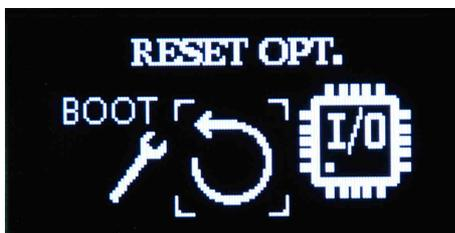
Schermata del menù ADV SETUP che identifica la pagina di RESET OPTION. Da questa pagina è possibile eseguire tre diversi tipi di reset del dispositivo FREEMK2 e FREENETMK2. Premere il tasto ENTER per accedere alla schermata di reset.
