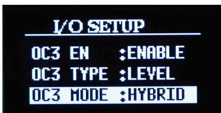
Schermata di modifica I/O SETUP. Il pin IL (OC3), collegato in parallelo tra più FREEMK2 e FREE∅ETMK2 permette l'accensione e lo spegnimento remotizzati (attraverso un contatto pulito bistabile o monostabile) del dispositivo, l'accensione e lo spegnimento simultaneo di più dispositivi tra di loro collegati, oppure il controllo degli accessori VIVALDI. Utilizzare i tasti << e >> per spostarsi da un parametro all'altro.
