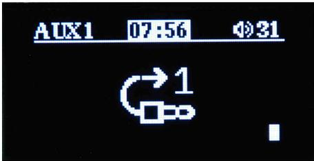
Schermata sorgente AUX1. FREEmk2 e FREE $\neg$ NETmk2 dispongono di due ingressi audio di linea stereo a morsetto, denominati AUX1 e AUX2. All'ingresso AUX1 è possibile collegare una qualsiasi sorgente audio a livello linea (1 Vrms). Premendo brevemente il tasto ENTER si attiva e disattiva la funzione MUTO (il valore del volume si porta a 0 e lampeggia). Premendo i tasti + e – si incrementa e decrementa
