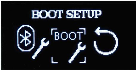
Schermata del menù ADV SETUP che identifica la pagina del BOOT SETUP. Da questa pagina è possibile configurare alcuni parametri di FREEMK2 e FREENETMK2 riguardanti la fase di avvio del dispositivo. Premere il tasto ENTER per accedere alla schermata di modifica.
