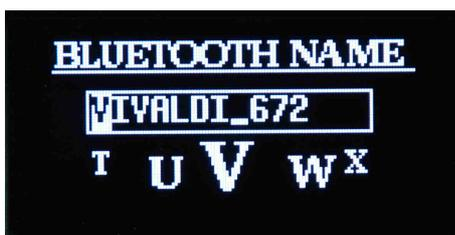
Schermata di modifica del nome del dispositivo Bluetooth integrato. Il nome di default è VIVALDI\_ (seguito da un codice alfanumerico univoco generato automaticamente da FREEMK2 e FREENETMK2). Utilizzare i tasti << e >> per spostarsi alla casella successiva. Utilizzare i tasti + e - per scorrere i caratteri alfanumerici e simbolici. E' possibile impostare un nome con un numero massimo di 14 caratteri. Una volta eseguite le
