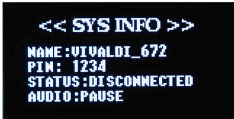
Schermata SYS INFO numero 5. Viene riportato il nome del dispositivo Bluetooth, il codice PIN di abbinamento al dispositivo Bluetooth, lo stato della connessione Bluetooth e lo stato dello streaming audio al dispositivo, se in play o pausa. Premere i tasti << e >> oppure i tasti + e – per visualizzare la schermata successiva.
