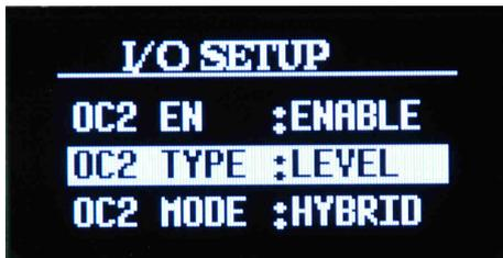
Schermata di modifica I/O SETUP. Il pin OC2, collegato in parallelo tra più FREEMK2 e FREE∅ETMK2 permette l'accensione e lo spegnimento remotizzati (attraverso un contatto pulito stabile o instabile) del dispositivo o l'accensione e lo spegnimento simultaneo di più dispositivi tra di loro collegati. Utilizzare i tasti << e >> per spostarsi da un parametro all'altro. Utilizzare i tasti + e - per modificare il
