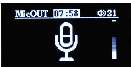
Schermata sorgente MIC OUT. FREEmk2 e FREEoNETmk2 dispongono della possibilità di usufruire dell'intercomunicazione microfonica tra due o più dispositivi connessi tra loro. La sorgente MIC OUT nello specifico, permette di sfruttare la capsula microfonica frontale integrata su FREEmk2 e FREEoNETmk2 (vedi capitolo 4.1 voce 2) per poter inviare un messaggio audio vocale ad uno o più
