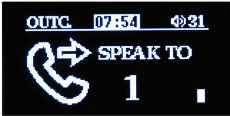
Quando sul display viene visualizzata la schermata come qui di fianco ed il numero dell'ID inizia a lampeggiare, la comunicazione microfonica è aperta verso l'ID selezionato. Premendo nuovamente il tasto MICROFONO la comunicazione microfonica verrà chiusa. La barra verticale a destra, indica il livello del segnale audio in ingresso.
