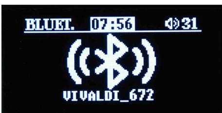
Questa schermata viene visualizzata quando un dispositivo Bluetooth è connesso a FREEmk2 e FREEnETmk2. Quando è attiva una trasmissione dati audio, il simbolo in schermata esegue un'animazione ed è attivo anche un led di colore blu, visibile tra le feritoie della scocca al di sopra del display (vedi capitolo 4.1 voce 1).
