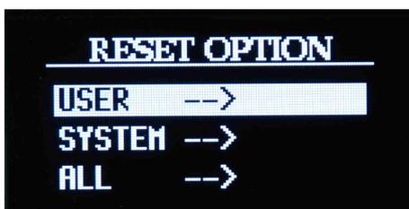
Schermata di RESET OPTION. FREEMK2 e FREENETMK2 permettono, attraverso queste funzioni, di eseguire tre diversi tipi di reset del dispositivo, sia per ripristinare i parametri di default del dispositivo, sia per risolvere a problemi momentanei di funzionamento del dispositivo. Utilizzare i tasti << e >> per
