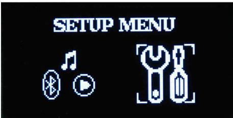
Schermata principale del menù SETUP. Viene visualizzata con dispositivo acceso, dopo una breve pressione del tasto MENU (ca. 2 sec.). Premere il tasto ENTER per accedervi.
