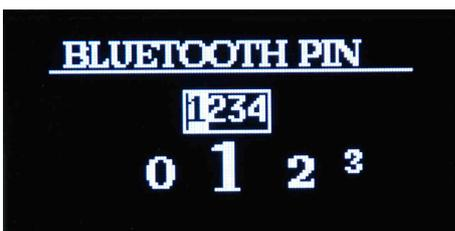
Schermata di modifica del codice pin di abbinamento al dispositivo Bluetooth integrato. Il codice pin di default è 1 2 3 4. Utilizzare i tasti << e >> per spostarsi alla casella successiva. Utilizzare i tasti + e - per scorrere i caratteri numerici. E' possibile impostare un codice pin di 4 cifre. Una volta eseguite le modifiche confermare premendo il tasto ENTER.
