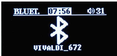
Schermata sorgente Bluetooth. FREEmk2 e FREEnETmk2 dispongono di un ricevitore Bluetooth integrato, che permette tramite una connessione Bluetooth a corto raggio (max 8 mt in aria libera) con un dispositivo mobile come uno smartphone, di effettuare uno streaming audio verso il FREEmk2 e FREEnETmk2. Quando viene selezionata questa sorgente, dal
