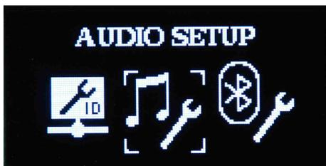
Schermata del menù ADV SETUP che identifica la pagina dell'AUDIO SETUP. Da questa pagina è possibile configurare alcuni parametri di FREEMK2 e FREE NETMK2 riguardanti l'amplificatore, l'uscita AUX OUT ed il microfono. Premere il tasto ENTER per accedere alla schermata di modifica.
