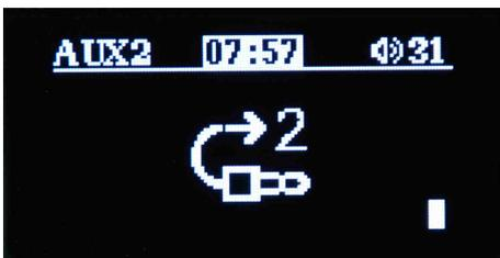
Schermata sorgente AUX2. FREEmk2 e FREE $\neg$ NETmk2 dispongono di due ingressi audio di linea stereo a morsetto, denominati AUX1 e AUX2. All'ingresso AUX2 è possibile collegare una qualsiasi sorgente audio a livello linea (1 Vrms). Nel modello FREE $\neg$ NETmk2, quando installato in abbinato alla matrice CA20/21, l'ingresso AUX2 è dedicato al segnale audio proveniente da quest'ultima. Pertanto, dal menù ADV SETUP
