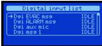
Il menu *Digital input list* permette di visualizzare lo stato degli ingressi digitali del sistema, vengono presentati sotto forma di elenco ed è possibile scorrerli mediante frecce SU e GIU. Ogni ingresso in lista è abbinato allo stato in sintesi:
