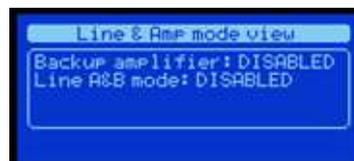
Il sotto menu **CONF LINE & AMP MODE** permette di visualizzare e configurare l'amplificatore di scorta ed il funzionamento della linea in modalità A&B.
