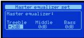
Il menu **CONF MASTER EQUALIZER** permette di visualizzare e configurare i parametri di equalizzazione dell'uscita audio del sistema.
