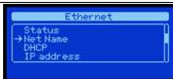
Nel menu ETHERNET vengono gestite le funzionalità di rete, è possibile visualizzare lo stato dell’interfaccia e configurarne i parametri di funzionamento. L’elenco delle funzioni è presentato come lista e può essere navigato mediante frecce SU e GIU, quando la selezione desiderata è puntata dalla freccia premere OK per accedere alla sezione.
