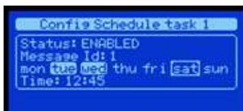
Quando il task è attivo, sul display compare un cursore che evidenzia il campo modificabile, con le frecce destra e sinistra è possibile spostarsi tra i vari campi modificabili. Mediante freccia SU e GIU è possibile modificare i campi in selezione. Premendo OK verranno salvate le modifiche. Premendo CANC verranno scartate le modifiche e la configurazione del *Task* non viene modificata.
