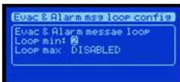
Il menu **CONF ALARM MESSAGE LOOP** permette di visualizzare e configurare il numero minimo e massimo di ripetizione dei messaggi pre-registrati di evacuazione ed allarme.
