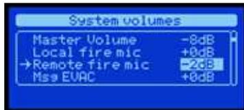
Per configurare un volume è sufficiente, selezionare la sorgente con le frecce SU e GIU, premere OK ed il volume puntato verrà evidenziato; utilizzando le frecce SU e GIU è possibile modificarne il valore, premendo OK il valore verrà salvato e applicato. Durante la configurazione il volume visualizzato viene applicato in tempo reale, premendo CANC si ritorna invece al valore precedente.
