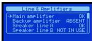
Il menu *Line & Amplifiers* permette di visualizzare e gestire lo stato degli amplificatori e le linee di diffusori. Vengono presentati sotto forma di elenco ed è possibile scorrerli mediante frecce SU e GIU. Ogni amplificatore e linee i diffusori è abbinato allo stato in sintesi:
