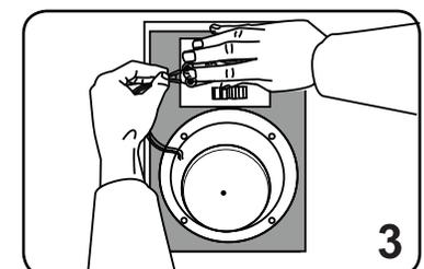
Alla stesura del cavo dell'altoparlante dall'amplificatore fino al punto di installazione, assicurarsi che il cavo finisca circa 30 cm (12") oltre alla foratura del muro.
