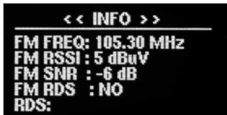
Schermata INFO numero 4. Se sul dispositivo FREEMmk3, FREENETmk3 e FREESOURCEmk3 è selezionata la sorgente RADIO FM o DAB+ e si va a visualizzare questa schermata, tramite il telecomando ad infrarosso TCIR5 in dotazione, è possibile con i tasti << e >> scorrere le varie frequenze FM/DAB+ e visualizzare quindi i valori sopra descritti per ogni frequenza/servizio selezionata. Premere i tasti << e >> oppure i tasti + e – per visualizzare la schermata successiva.
