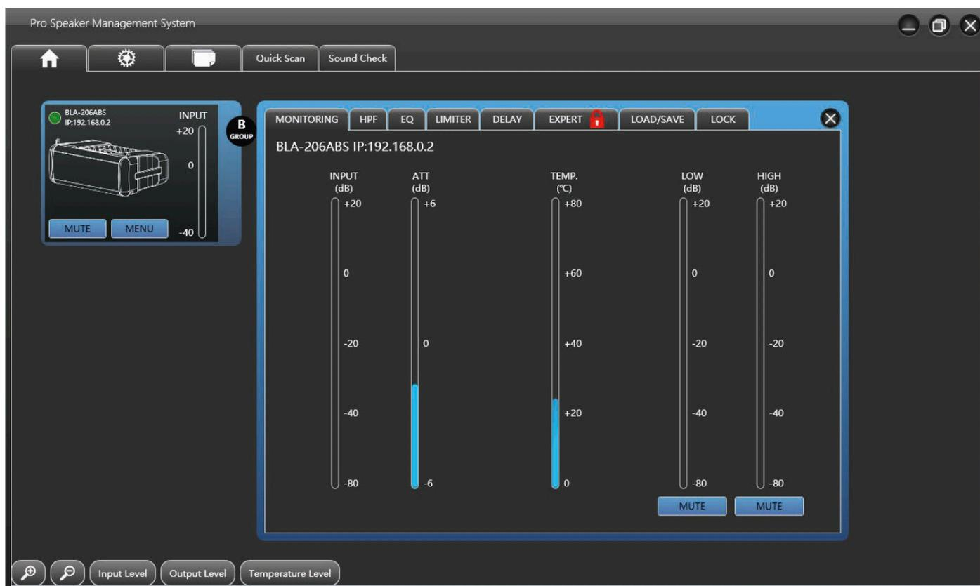
Monitoraggio in tempo reale del tuo impianto. Da questa pagina è possibile MUTE separatamente l'altoparlante superiore e l'altoparlante inferiore secondario.
