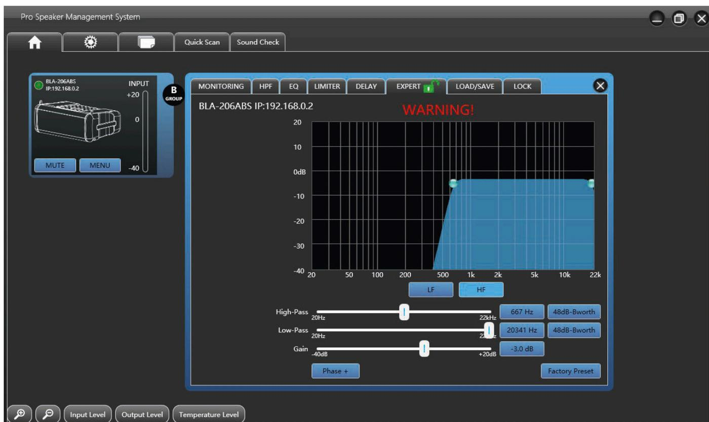
Un crossover viene utilizzato per dividere il segnale a banda larga in bande di frequenza separate. Ciò consente a ciascun driver di un sistema di altoparlanti di funzionare all'interno della sua gamma di frequenze operative. L'utilizzo del crossover attivo aumenta l'efficienza di ogni driver ma anche dell'amplificatore abbassando la distorsione di intermodulazione.
