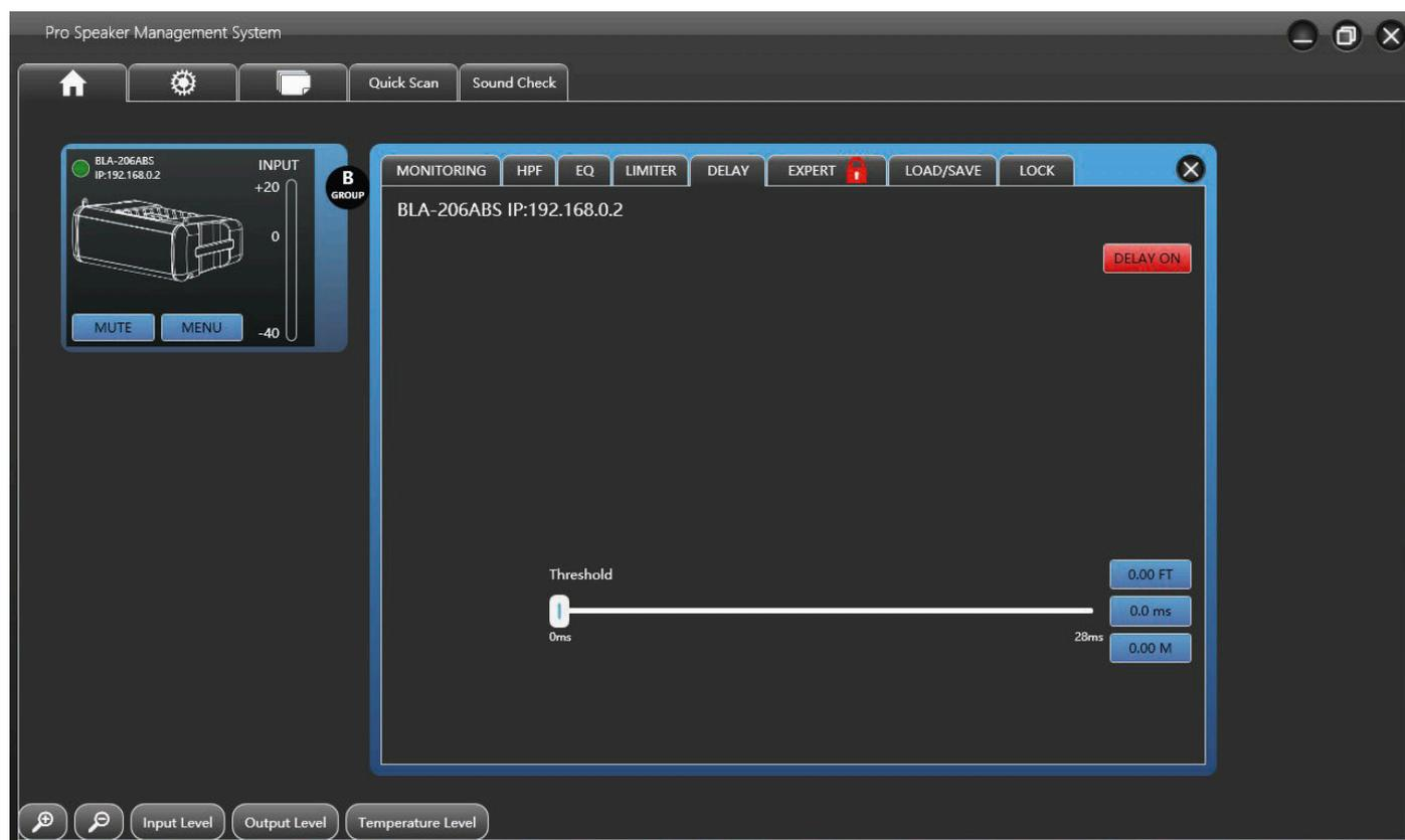
Potrebbe essere necessario aggiungere un ritardo al sistema di altoparlanti a seconda della sua posizione nell'installazione. Non è necessario un sistema di gestione degli altoparlanti esterno. Puoi farlo direttamente con il software LA350HP. Per aiutarti nella regolazione del ritardo, il ritardo viene visualizzato in M (metro), ms (tempo in millisecondi) e FT (piedi)
